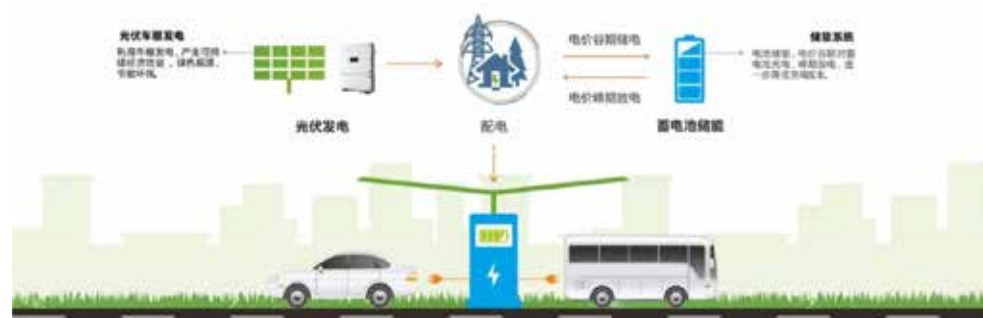
图 8-3 光储充检一体化原理基本示意图
